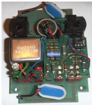
AR-116 の内部 大型のトランスを内蔵している
