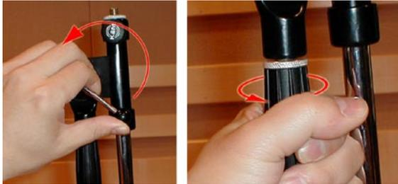
軸の部分の少し持ち上げて、リングねじを時計回りに締めて、軸との間に隙間がない状態にする
