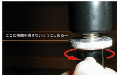
次に軸の部分と同じく時計方向に回し、ブーム部分としっかり固定する。
